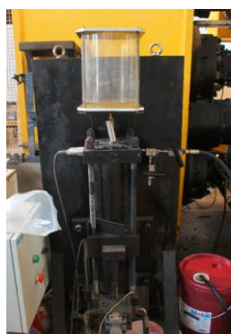
图 3 压裂泵伺服控制系统
