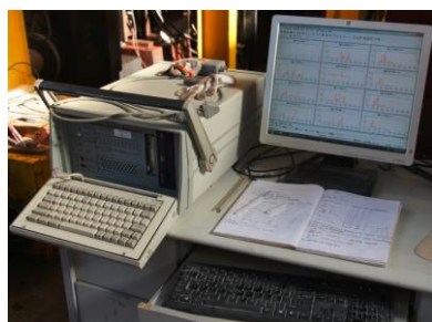
图 4 Disp 声发射检测系统
