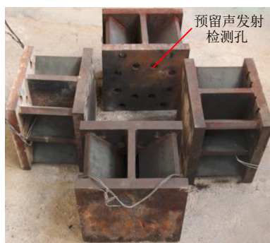
图 5 试验机加载板
