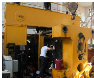
图 2 真三轴物理模型试验机
